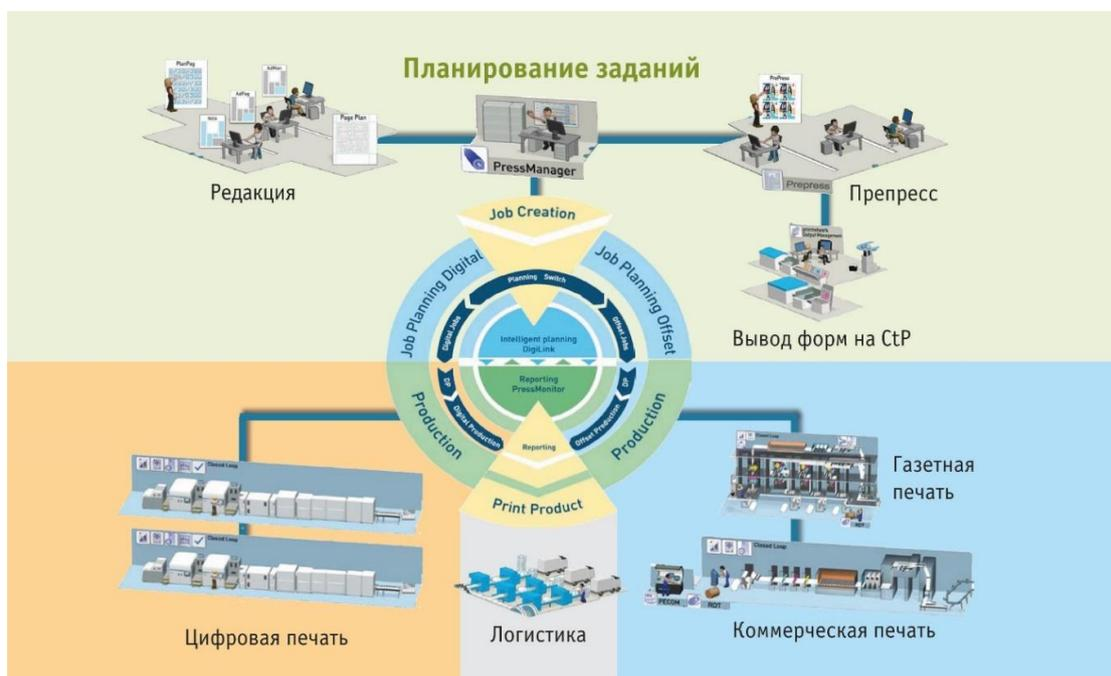
Общая схема организации автоматической одновременной печати изданий (или их частей) при помощи разных технологий. Например, когда часть издания печатается на газетной бумаге, часть – на мелованной, а сигнальные (или особо срочные) экземпляры этого издания – цифровым способом.
